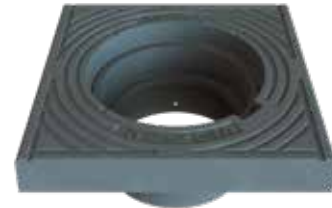
Säädettävä kehys Ø 300 h=200 kahdelle kannelle Laippa nelikulmainen 450 x 450
