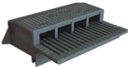
Asennusesimerkki. Kitasieppari 830 x 295 H=200 mm asennettuna kitakaivon kehykselle 830 x 400 mm
