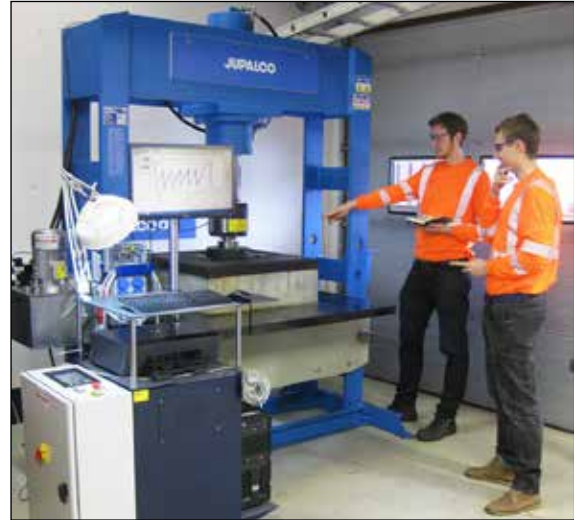
EN124 normin mukainen tietokoneohjattu testauslaite.
