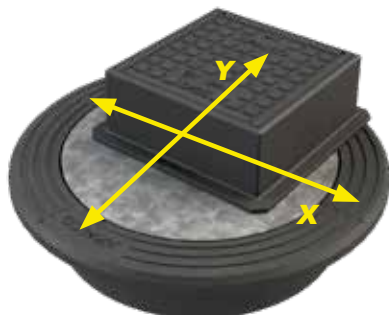
Esimerkkiratkaisu. 335 x 335 mm neliökansisto asennettu soviteosaan. Asennetaan 600 mm:n betonikartiolle tai muoviputkille 560 tai 630 mm
