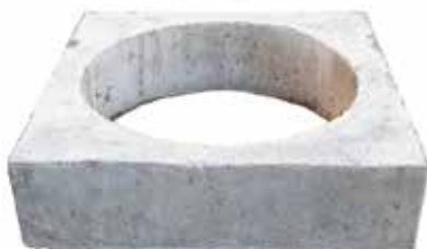
Betoninen korotuskehys ulkomitta 750 x 750 mm aukko Ø 600 mm, h=200 mm
